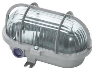
Deverá ser fornecida e instalada luminária para sinalização blindada a prova de tempo (sinalizador de topo), base para lâmpada E-27, incluindo a lâmpada, corpo em alumínio fundido, acabamento com pintura eletrostática a pó na cor cinza, lente de macrolon rosqueada ao corpo, entrada de 3/4" BSP (gás), soquete de porcelana, cor: vermelho.
